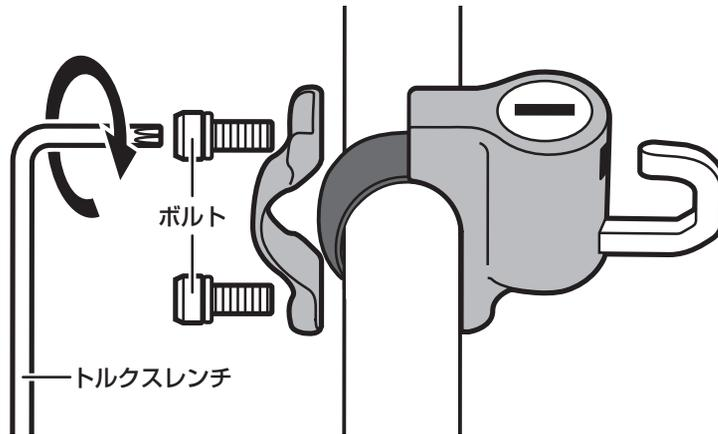
② ロックをラバーパッドに合わせて、トルクスレンチでハンドルバーに固定します。
