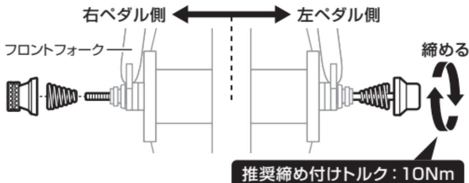
推奨締め付けトルクに従い、5mm六角レンチでスキューワースを締めて固定します。
