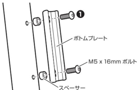
① ボトムプレートとスペーサーをボトルケージ台座に M5 x 16mm ボルトで固定します。
