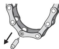
リンクピンからガイドピンを抜き取ります。最後にチェーンフィクサーを取り外します。
