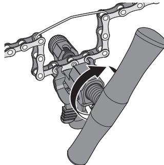
ブッシュピンとコネクティンの中心を合わせてフィクサーでチェーンを固定し、ハンドルを時計方向に回し圧入します。
