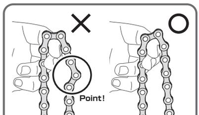
チェーンを接続した部分が滑らかに動き、自由に曲がらないリンクがないことを確認してください。自由に曲がらないリンクがある場合は、リンクを上下左右に優しく曲げて接続部分をなじませます。
