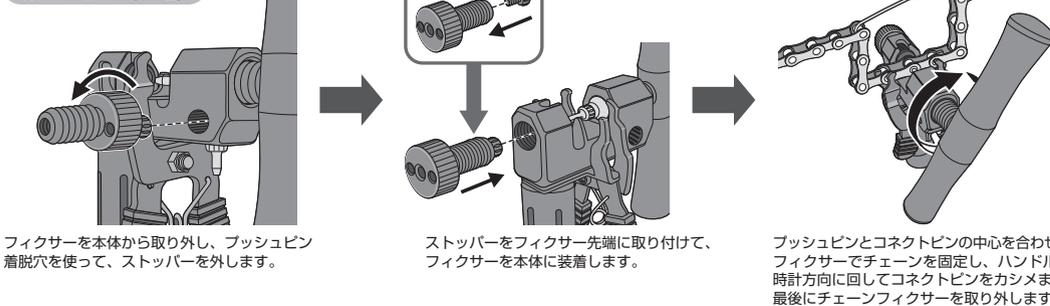
フィクサーを本体から取り外し、ブッシュピン着脱穴を使って、ストッパーを外します。
