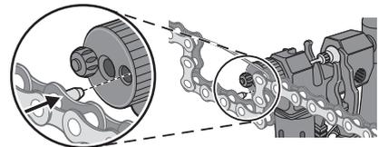
飛び出したコネクティンをアンブル破断穴に差し込み、コネクティンの余分な部分を折ります。最後にチェーンフィクサーを取り外します。
