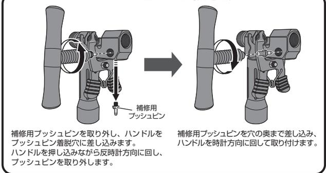
補修用ブッシュピンを取り外し、ハンドルをブッシュピン着脱穴に差し込みます。ハンドルを押し込みながら反時計方向に回し、ブッシュピンを取り外します。
