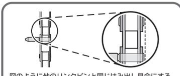
図のように他のリンクピンと同じはみ出し具合にする。
